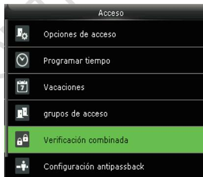
Presione ▼ para seleccionar la verificación combinada y pulse OK
