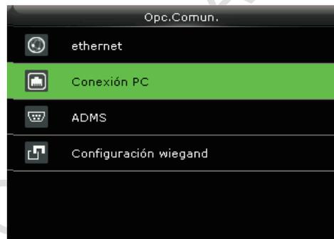
Utilice la tecla ▼ para desplazarse por las opciones. Elija “Conexión con el PC” y presione OK.
