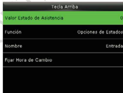
Presione ▲/▼ y presione OK para seleccionar las opciones. Cuando la configuración esté completa, presione OK para guardar y salir.
