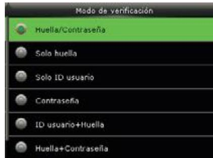
Presione ▲/▼ para seleccionar el modo de verificación, presione OK para guardar y salir.
