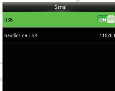
**RS232/USB:** Si desea utilizar la interfaz RS232 o la USB para comunicación, por favor utilice la barra para activar la función.
