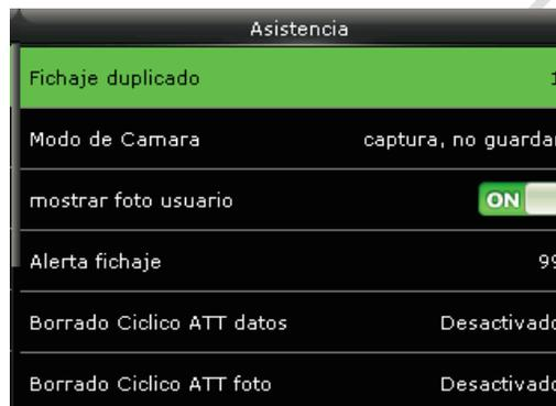
Utilice las teclas ▲▼ para moverse por el menú y presione OK para seleccionar las opciones. Cuando la configuración esté completa, presione OK para guardar los cambios y salir de esa interfaz.
