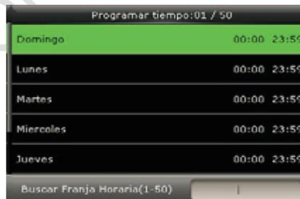
Utilice las teclas numéricas para buscar un horario en el intervalo de 1 a 50. Presione ▼ para seleccionar el elemento que desea ajustar y presione OK.
