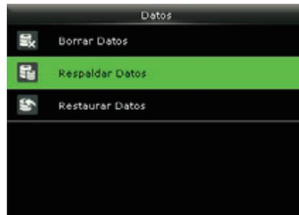
Presione ▼ para seleccionar respaldar datos y pulse OK
