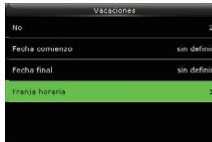
Presione ▼ para seleccionar un horario y pulse OK.
