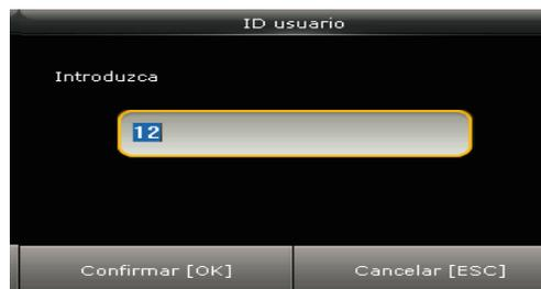
Ingrese el ID de usuario utilizando el teclado del dispositivo, presione [OK]. Ubique adecuadamente la huella en el sensor.
