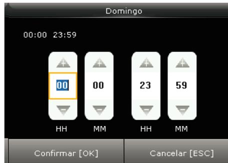
Presione ◀ / ▶ para seleccionar una opción de tiempo y presione ▲ / ▼ para ajustar la hora. Después de establecer un período de tiempo, pulse Aceptar para guardar la configuración y salir
